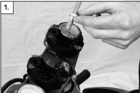
Grundträger (1) mit vormontierten Kegelgummi (2) auf die Gabelbrücke aufschrauben (M10x25) (4) und mit 40Nm festschrauben. Wenn nötig Erhöhungen (3) beilegen, dabei jedoch die Schrauben M10x35 verwenden.
