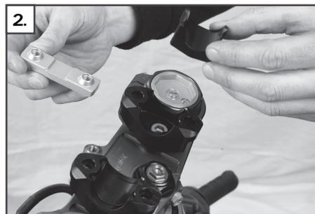
Insérez la barre de serrage (6) dans le support de base (2) (cône vers le haut) et encliquez la coupelle inférieure du guidon (7) dans la barre de serrage (6).
