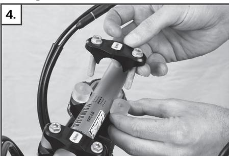
Enfiler les coupelles supérieures du guidon (10) avec le caoutchouc intermédiaire pré-assemblé (9), les vis M8x45 (11) et les élastomères (8).
