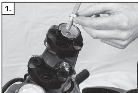
Visser le support de base (2) avec le cône en caoutchouc pré-assemblé (3) sur le pont de fourche (M10 x 25) (4) et visser à 40 Nm. Si nécessaire, ajoutez des rehausseurs de guidon (1), mais utilisez les vis M10 x 35 (5). **REMARQUE : Assurez-vous que la direction de décalage est la même.**
