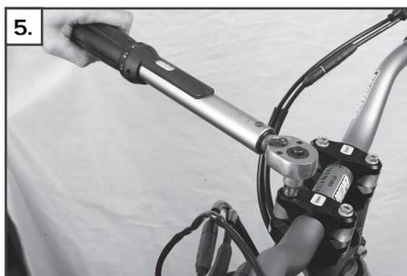
Visser uniformément les vis M8x45 (11) et serrer à 20 Nm. Assurez-vous que l'écart de serrage entre les coquilles (7) + (10) est le même (Voir l'image bien/mal).
