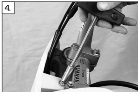
4. Startnummerntafel modellabhängig demontieren
