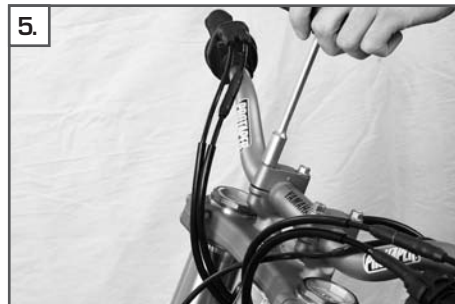
5. Lenker und eventuelle Befestigungen wie Kabelbinder demontieren
