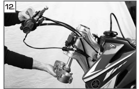
12. Untere Gabelbrücke demontieren, den Lenkkopf und den Lagersitz des Motorrades reinigen.
