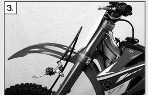
3. Bremspumpe an Bremsleitung montieren
