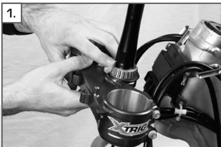
1. Das Lenkkopflager der vormontierten XTRIG Gabelbrücke mit geeignetem Lagerfett einfetten.
