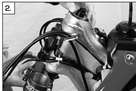
2. Die untere Gabelbrücke in den Lenkkopf einschieben, dabei das obere Lenkkopflager und die Dichtscheibe gegenhalten.
