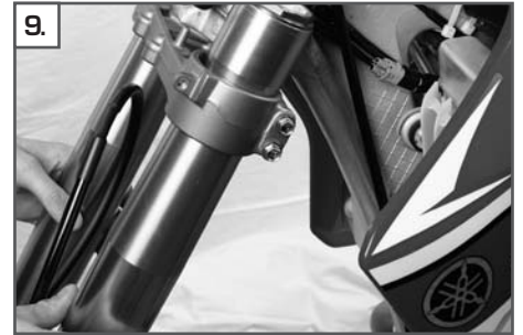
9. Gabel samt Vorderrad und Bremsanlage nach unten herausziehen.
