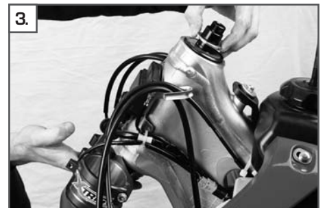
3. Nun Modellabhängig die Abdichtung für das Lenkkopflager montieren (Dichtscheibe oder O-Ring)
