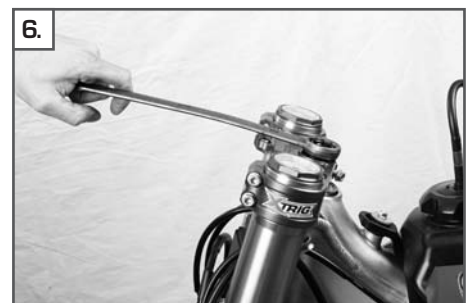
6. Das gewünschte Lagerspiel mit der Einstellmutter ( 4 ) einstellen.
